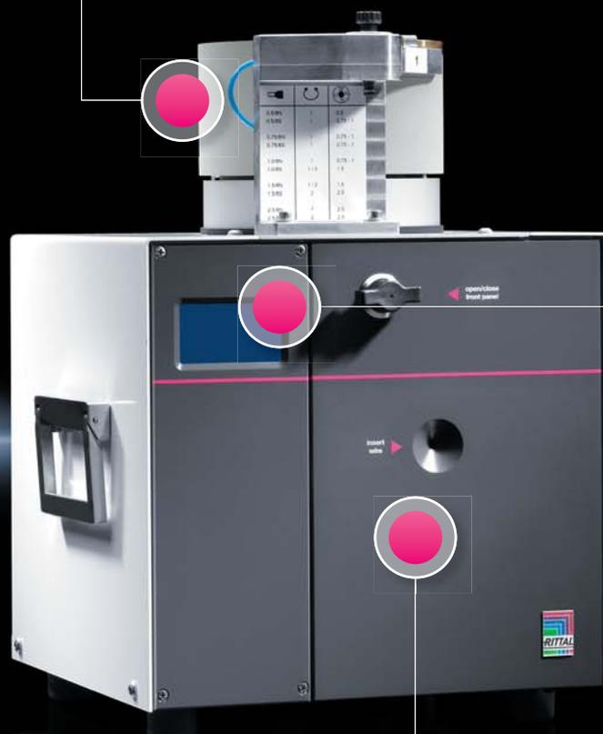
■ Les sections des conducteurs de 0,5 à 2,5 mm<sup>2</sup> peuvent être usinées
